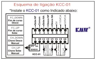
\*O controlador de cortinas KCC-01 é um equipamento destinado ao controle automático de cortinas, sendo índicado para uso Avícula ou outros ambientes como: Chiqueirões e Granjas de Matrizes e qualquer outro ambiente que necessite de um controle rígido de temperatura.
